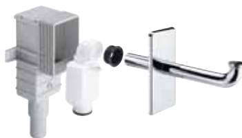
Sifon (5633.1) za podžbuknu zidnu ugradnju. Pokriva ploča od plastike, kromirana. Podesiv po visini, za završnim kromiranim lukom od mesinga.
