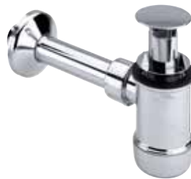
Sifon (5421) kompletno kromiran, za umivaonike bez prelivne rupe. Odvodna vertikalna cijev se može izvući za 90 mm.
