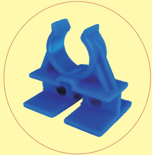
**Namena:** Kod podnog grejanja za pričvršćenje ALUPLAST cevi na podužnim i poprečnim žicama armaturne mreže. Time se postiže fiksiranje cevi na željeni razmak i efekat distanciranja armaturne mreže od podloge za 10 - 14 mm.
