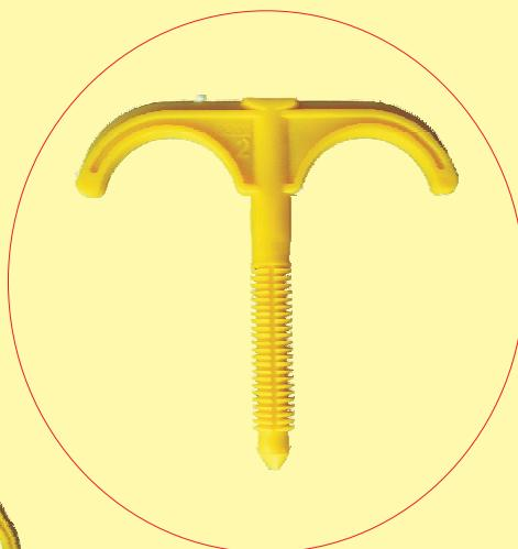
**Namena:** Pričvršćivanje - sidrenje aluplast cevi i gibljivih PP cevi (bužira) kod podnog dvocevnog razvoda grejanja. Isti se koristi za fiksiranje lukova u paru spojenih zupčastom spojnicom art. 03-01 plus art. 03-02. Prednost ovog načina je da izbacuje upotrebu tiple a povećava efikasnost montaže, koja se vrši bušenjem jedne rupe fi 8 u betonskoj podlozi.
