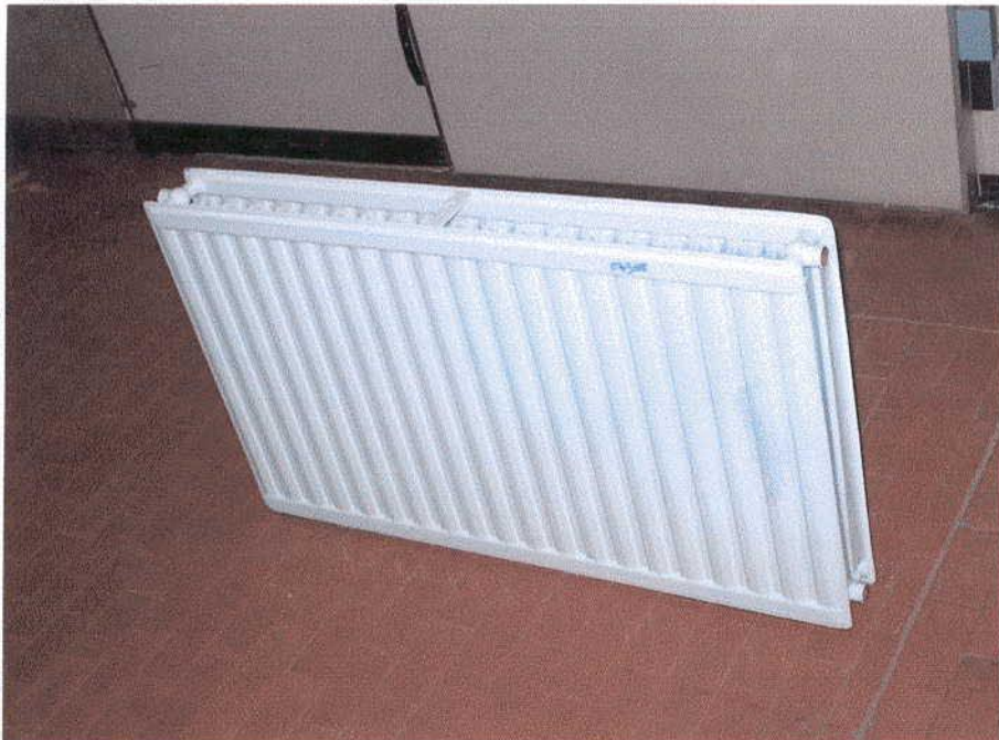
ATITA 3910 - Test 04308 - Nuova Imas 22 KE 600 x 1000 Prof.: 112 mm; H conv.: 500 mm; L conv.: 1000 mm
